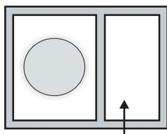
Einzüger mit Luft-/Kabelschacht
