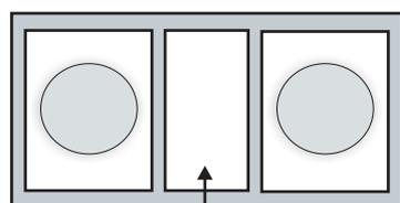
Zweizüger mit Luft-/Kabelschacht
